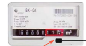
Beépített mágnes a gázórában
