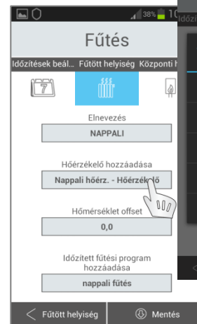
21/6-7. ábra: Kattintson a „Hőérzékelő hozzáadása” gombra és az előugró ablakban válassza ki a fűtési zónához tartozó hőérzékelőt. (melyet az eszközknél már felvett a rendszerbe)
