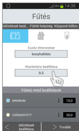
20/5-6. ábra: Adjon nevet az időprogramnak, majd nyomja meg a hiszterézis mezőjét és a nyilakkal állítsa be a hiszterézist a kívánt értékre (0,5 - 5°C). Nyomja meg az „OK” gombot. (Pl.: 0,5°C hiszterézisnél 1°C különbséggel fog be- és kikapcsolni)
