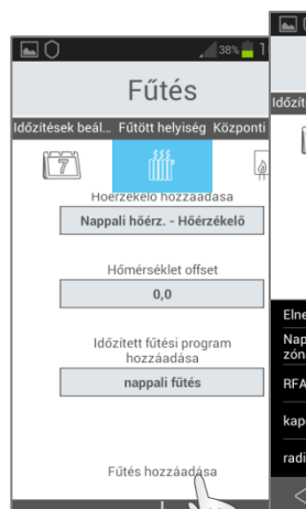
21/12-13. ábra: Kattintson az „Fűtés hozzáadása” gombra, majd a megjelenő felületen válassza ki az adott fűtési kör zónavezérlőjét (szelepmozgató, RFATV-1), és jelölje meg, ha a zónához központi hőforrást is szeretne kapcsolni. Több zónavezérlő is választható egy fűtési körhöz!
