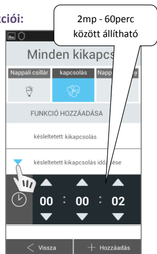
24/10-11. ábra: Idő beállítással együtt a késleltetett kapcsolás az itt megadott időzítés szerint fog működni, ezt tárolja el az aktor. (Figyelem! Az első parancs még az aktorban utoljára tárolt időzítéssel fog működni.)
