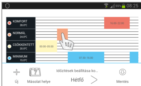
20/20. ábra: Egy, már beállított időtartomány fűtési üzemmódjának módosításához tartsa ujját a módosítandó időszávon.
